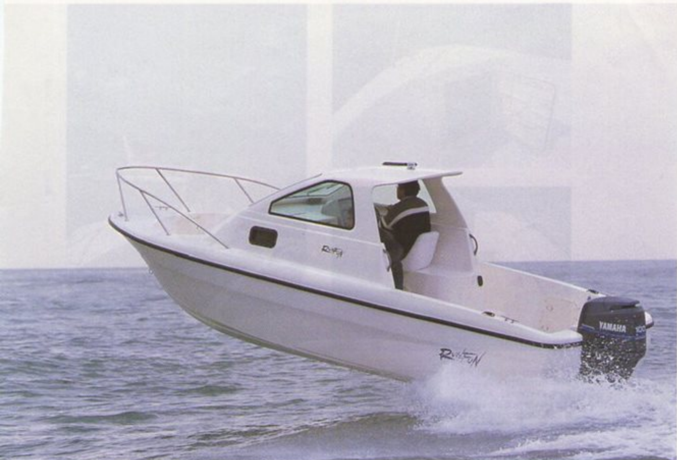
テスト海面となった浜名湖で、F100Aを搭載した22は5,500回転で33ノットを出す。
