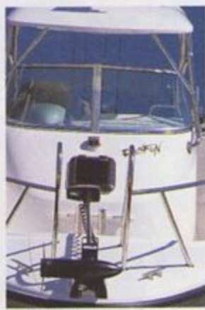
ミニコタ製40ポンドパワーモーターがセットされる。取付けというよりも、設計段階でパワーモーターが考えられていて、その意味でごく自然にフォルムにマッチする。
