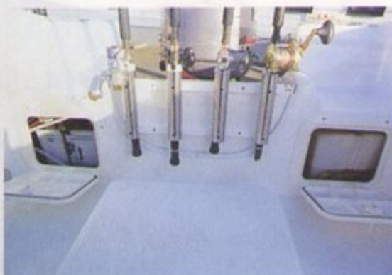
4連のロッドホルダーの設置は、フィッシングユーザーにとっては有り難い設備。スターンベンチを兼ねたストレージ内部はバッテリースペースなどとして利用。
